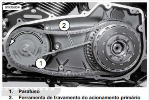
Figura 4. Remova o parafuso da roda dentada de compensação
